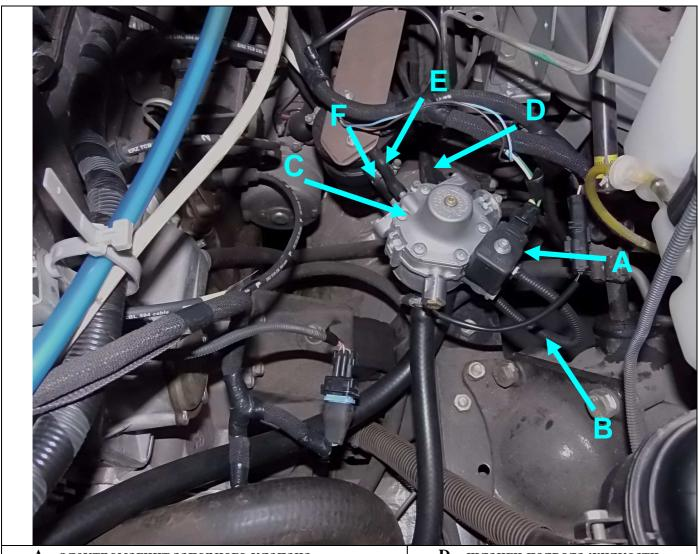
А – электромагнит запорного клапана
