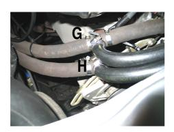
Патрубки редуктора-испарителя подключаются к системе охлаждения двигателя. Для подключения используются пластмассовые тройники и специальные резиновые шланги внутренним диаметром 16 мм, отвечающие требованиям Правил 67 ЕЭК ООН. Врезка в систему охлаждения осуществляется в точках G и H. Перед подключением необходимо слить жидкость из системы охлаждения в подготовленную ёмкость.
