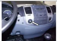
Для установки переключателя, необходимо в заглушке сделать отверстие диамтром 8...9 мм и протащить через него жгут подключения переключателя. Затем подключить розетку жгута к переключателю и снять защитную плёнку с самоклеющейся части переключателя. После этого прижать переключатель к посадочной поверхности (заглушке), после чего установить заглушку на место.
